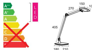
La ref. 5042 E-MOTION dispone de sensor de movimiento en el cabezal, para facilitar el encendido y apagado de la lámpara
